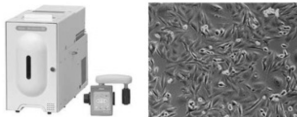
Рисунок 9. Биостанция Nikon IM-Q и фотография микроорганизмов, полученная с помощью встроенного микроскопа биостанции IM-Q
