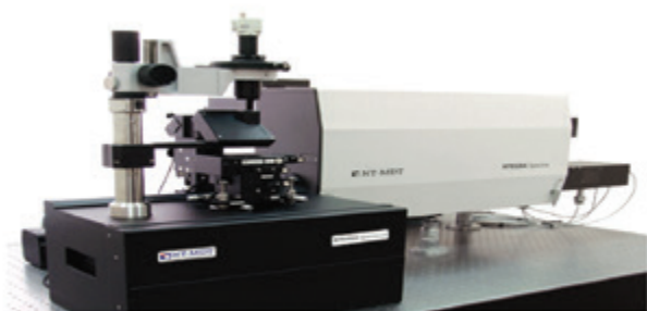
Рисунок 6. Аналитико-технологический комплекс ACM NTI Spectra и 3D-изображение поверхности полимерной пленки полистирола, полученное при его помощи
