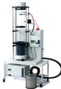
Рисунок 1. Внешний вид нанораспылительной сушилки и порошка с частицами субмикронного размера, полученного с ее помощью
