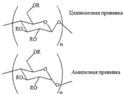
Рисунок 17. Модификация силикагеля циклодекстрином или его производными
