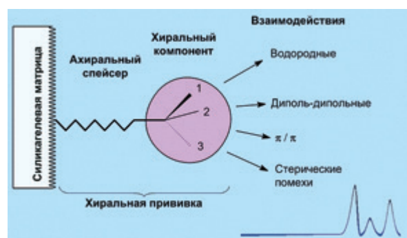
Рисунок 15. Схема, иллюстрирующая модификацию сорбента хиральными прививками
